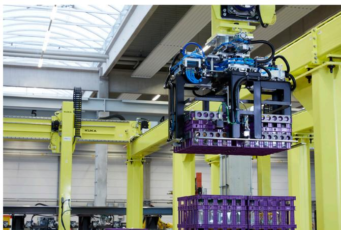
Der KUKA Roboter kann mit seinem mechanischen Greifer eine komplette Lage Getränkekartons anheben.
