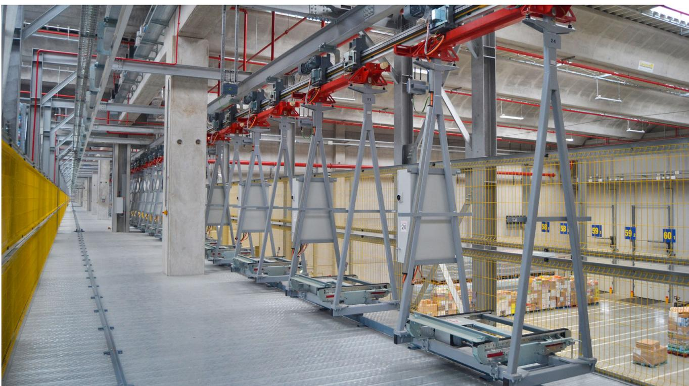
Ein Hängebahnsystem befördert die Paletten innerhalb des Almarai-Produktionskomplexes – allein im Logistikzentrum sind 40 Wagen in Betrieb.
