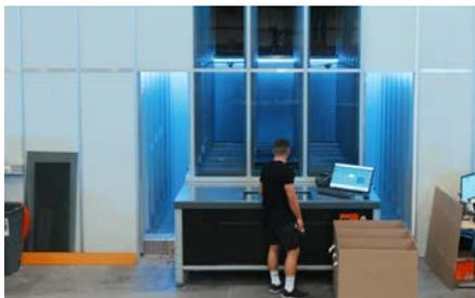
Im **RelayPort** können Roboter mehrere Lagerbehälter parallel ablegen und aufnehmen, um die Sequenzierung von Aufträgen zu verbessern.
