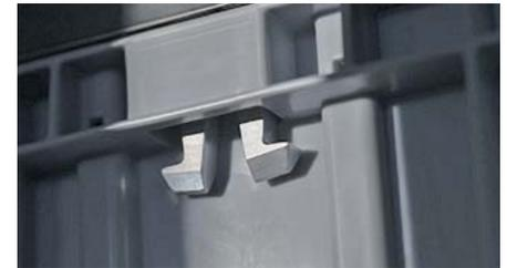
Die Gripperplatte des Roboters hakt sich für den Transport sicher in die jeweilige Lagerbox ein.
