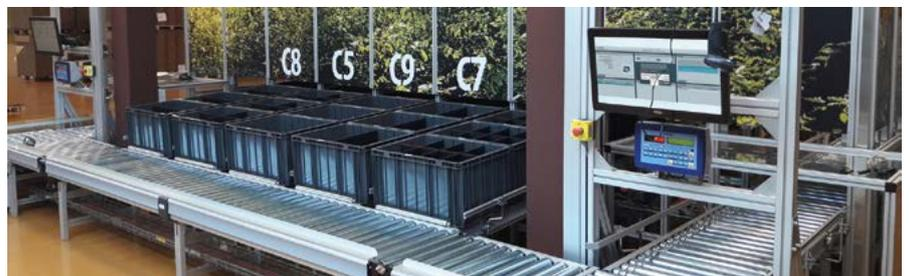
Der **ClusterPort** ist eine Eigenentwicklung von Swisslog für die hocheffiziente Einlagerung von Produkten. Die Behälter mit der benötigten Unterteilung werden vollautomatisch durch die Software zur Einlagerung bereitgestellt.
