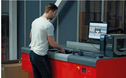
Der **CarouselPort** ist der meist eingesetzte Port. Drei rotierende Arme sorgen für die fortlaufende und nahtlose Bereitstellung der Lagerbehälter. Dadurch erreicht man eine sehr hohe Einlager- und Pickleistung.
