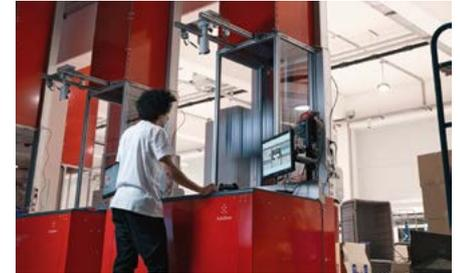
Der **SwingPort** kann an beliebiger Stelle unterhalb der Rasterkonstruktion platziert werden und verfügt über einen direkten Anschluss an den Lagerbehälter-Lift. Es rotieren zwei Arme.
