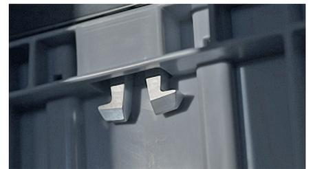
La placa de agarre del robot se engancha de forma segura en la cubeta de almacenamiento correspondiente para su transporte.
