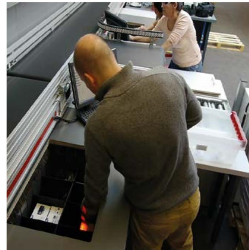
Ein weiterer Bestandteil der Lösung bei Competec ist die QuickMove-Leichtgut-Förderanlage. Diese stellt den raschen Transport der Kundenpakete in Richtung der automatischen, vollintegrierten Volumenreduktions- und Kartonverschleißmaschinen sicher. Nach der nachgelagerten automatischen Versand-Etikettierung werden die Pakete dann über die Fördererntechnik zu den einzelnen Verladezielen befördert.
