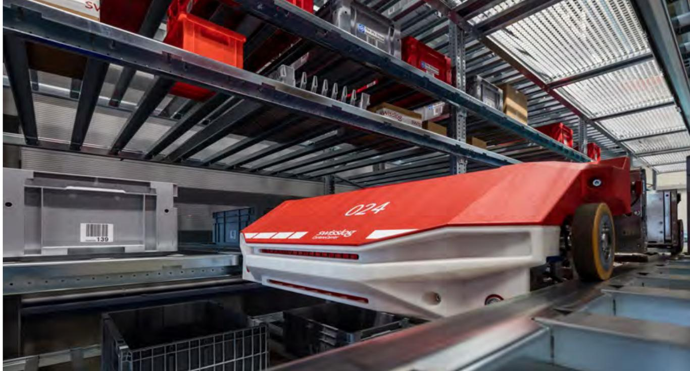
CycloneCarrier im Einsatz: Das Hochgeschwindigkeitsshuttle ist bis zu 4 m/s schnell.
