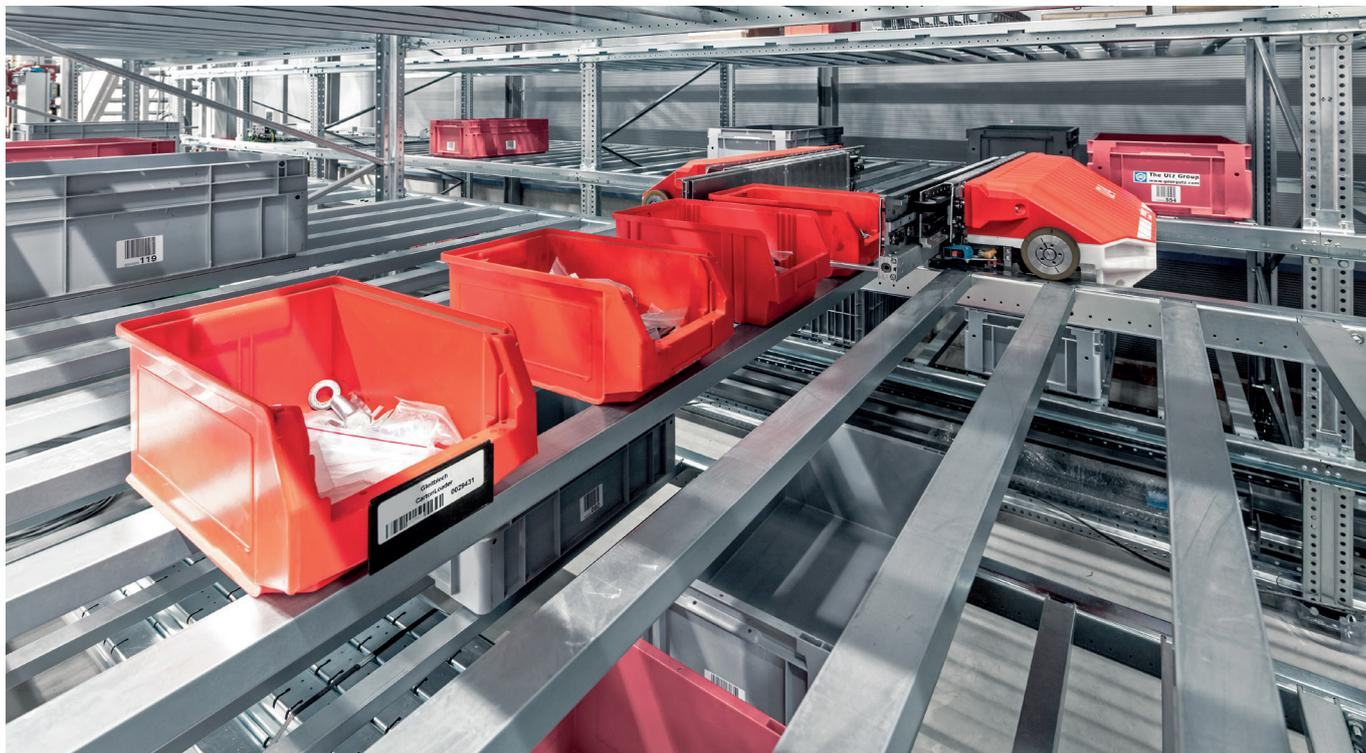
Einer der Bestandteile der neuen Wala-Logistik: Mit dem neuen Shuttle-System CycloneCarrier erreichen Lagern, Kommissionieren und Konsolidieren von Aufträgen einen enormen Effizienzgrad.
