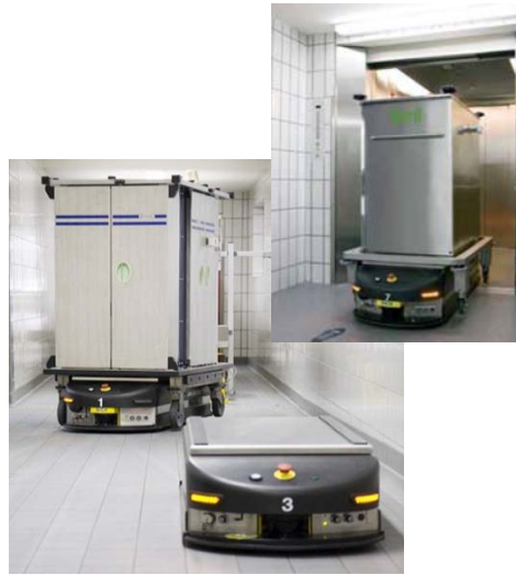
Fahrerlose Transportsysteme für schwere Plantransporte
