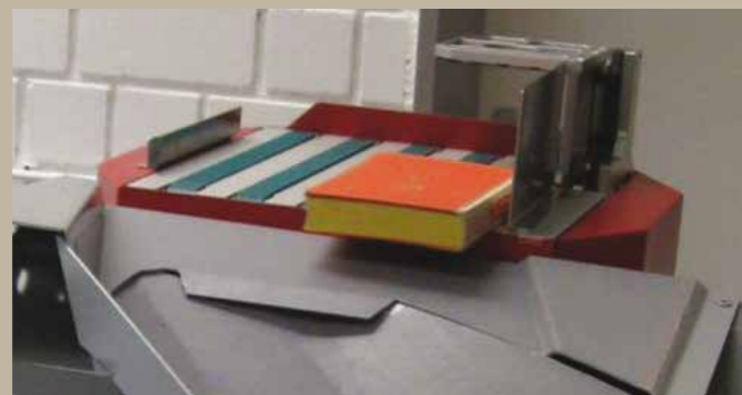
UniSortCar – Automatische Be- und Entladung über Buchrutsche
