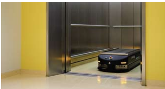
Die lasergesteuerten Fahrerlosen Transportsysteme (FTS) navigieren selbständig im Gebäude, auch über Stockwerke hinweg.
